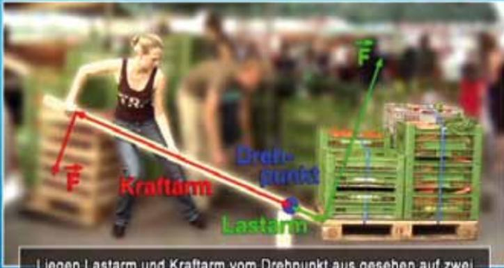
Liegen Lastarm und Kraftarm vom Drehpunkt aus gesehen auf zwei verschiedenen Seiten, so spricht man von einem zweiseitigen Hebel.
